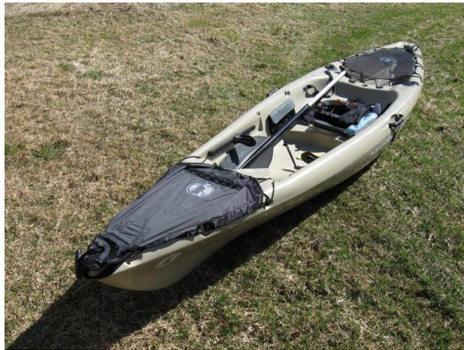
Abbildung 15: Ein schmales Boot hat einen kleinen Wasserwiderstand und erreicht deswegen eine höhere Geschwindigkeit. Dafür ist ein breites Boot stabiler und kentert nicht so leicht.
