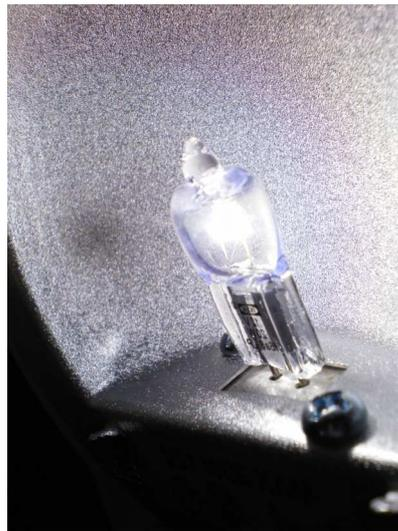
Abbildung 6: Gemäß dem Stefan-Boltzmann-Gesetz steigt die abgestrahlte Lichtleistung mit der vierten Potenz der Temperatur des Glühfadens. Eine Temperaturerhöhung ist daher ein effizientes Mittel zur Steigerung der Effizienz einer Lampe. Leider verschleißt eine Lampe um so schneller, je höher die Temperatur des Glühfadens ist. Eine Halogenlampe ist ein Ansatz, diesen Widerspruch zu vermindern.
