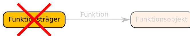
Die Trimmingregel B besagt, dass der Funktionsträger getrimmt werden kann, wenn das bisherige Funktionsobjekt die Funktion übernehmen kann. Das bisherige Funktionsobjekt wirkt dann also auf sich selbst.
