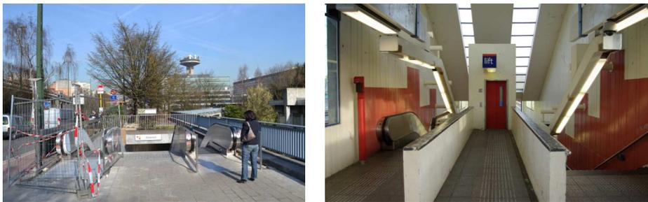
Abbildung 43: Eine Rolltreppe bietet den Vorteil, direkt neben einer normalen Treppe angebracht werden zu können. Für einen Aufzug ist dagegen ein getrennter horizontaler Zugangsweg notwendig.
