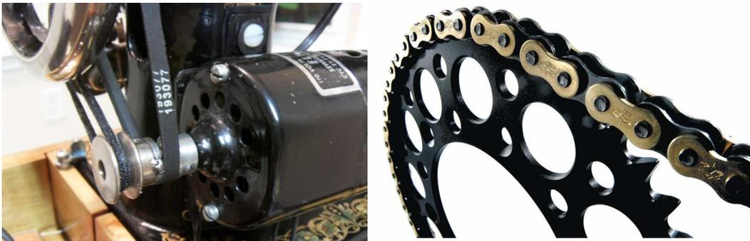
Abbildung 28: Ein Keilriemen kann nur eine begrenzte Kraft übertragen, bevor er reißt. Eine Kette ist deutlich belastbarer.
