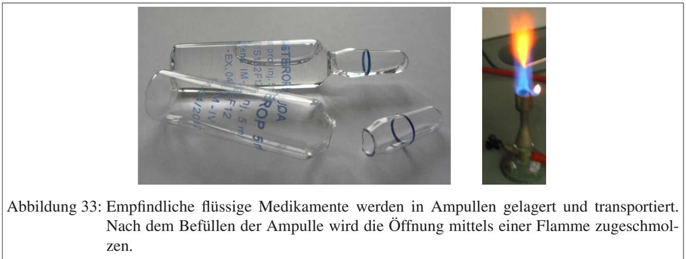
Abbildung 33: Empfindliche flüssige Medikamente werden in Ampullen gelagert und transportiert. Nach dem Befüllen der Ampulle wird die Öffnung mittels einer Flamme zugeschmolzen.
