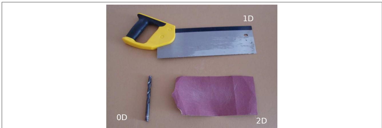
Abbildung 2: Diese drei Werkzeuge entfernen Material von einem Werkstück. Beim einem Bohrer ist der Kontaktbereich ein Punkt (nulldimensional), eine Säge sägt entlang einer Linie (eindimensional), während Sandpapier flächig abträgt.
