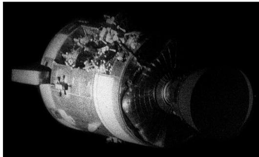
Abbildung 19: Die Explosion im Versorgungsmodul von Apollo 13 war so stark, dass sogar ein Teil der Verkleidung abgesprengt wurde. Das genaue Ausmaß des Schadens war jedoch während der Mission unbekannt, da dieses Foto erst kurz vor dem Wiedereintritt der Raumkapsel in die Erdatmosphäre aufgenommen werden konnte.
