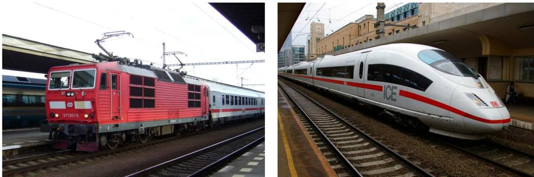
Abbildung 24: In einem Zug müssen alle Achsen mit einer Bremse versehen sein. In einem traditionellen Zug (links) sind nur wenige Achsen angetrieben, nämlich die der Lokomotive, während in einem Triebwagenzug (rechts) dagegen alle (oder zumindest viele) Achsen in den Waggons mit einem Motor versehen sind. Diese Motoren können auch als Bremse genutzt werden.
