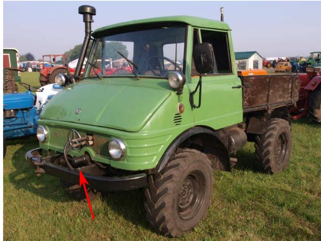
Abbildung 23: Bei Unimogs wird die Motorenwelle nach vorne herausgeführt. Hierdurch können Arbeitsvorrichtungen an ihm montiert und vom Motor angetrieben werden.
