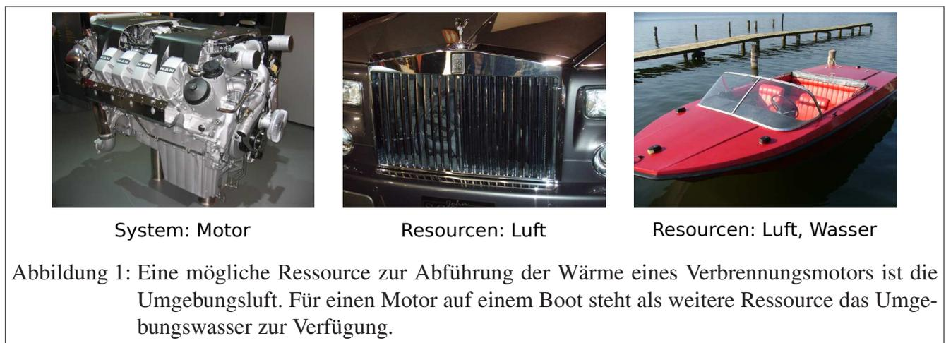
Auf einem Boot steht ebenfalls die Umgebungsluft als Ressource zur Verfügung. Es gibt jedoch noch eine weitere, viel effizientere Ressource, nämlich das Wasser, in dem das Schiff fährt. Aus diesem Grund werden alle Schiffsmotoren nicht mittels Umgebungsluft, sondern viel effizienter mit Wasser gekühlt.
