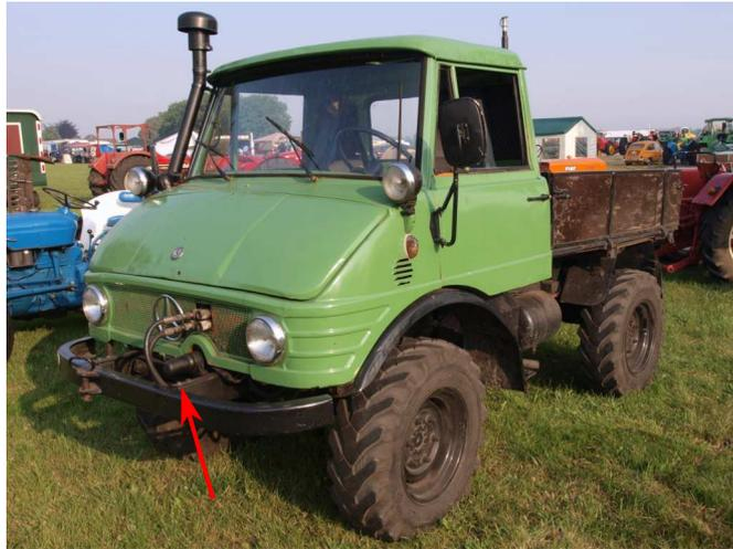
Abbildung 6: Bei Unimogs wird die Motorenwelle nach vorne herausgeführt. Hierdurch können Arbeitsvorrichtungen an ihm montiert und vom Motor angetrieben werden.
